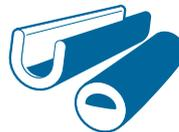
ガラス転移点以上の温度で変形させた形状を保持したままガラス転移点以下に冷却するとその形状で固化します。再びガラス転移点以上の温度に加熱すると記憶された形状に戻ります。
